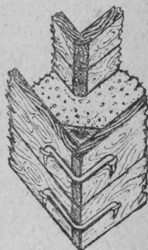
Рис. 13. Крепление щитов к углу.
